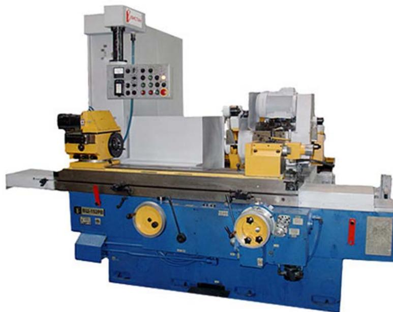
Полуавтоматы моделей VCA-1U52 NC (ВШ- 152УВИ) и VCA-1R52 NC, (ВШ-152РВИ) предназначены для шлифования поверхностей тел вращения из различных материалов методом врезного и продольного шлифования деталей в центрах и патроне.
