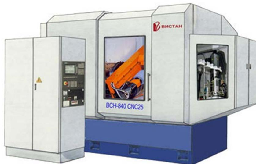
Зубошлифовальный полуавтомат с синхронными электронными кинематическими связями мод. BCH-840CNC25 предназначен для обработки прямозубых и косозубых цилиндрических зубчатых колес, шлицевых валов методом обката и единичного деления в условиях единичного и серийного производства.
