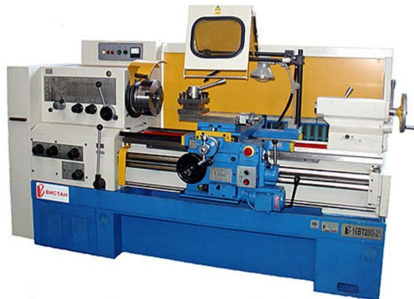
Станок повышенной точности 16BT20П предназначен для выполнения разнообразных токарных работ и нарезания метрической, дюймовой и питчевой резьбы.
