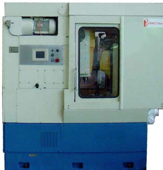
Вертикальный зубодолбежный полуавтомат предназначен для обработки прямозубых цилиндрических зубчатых колес наружного и внутреннего зацепления методом обката. Полуавтомат имеет компоновку с вертикальной осью изделия и подвижным столом для изменения межцентрового расстояния.
