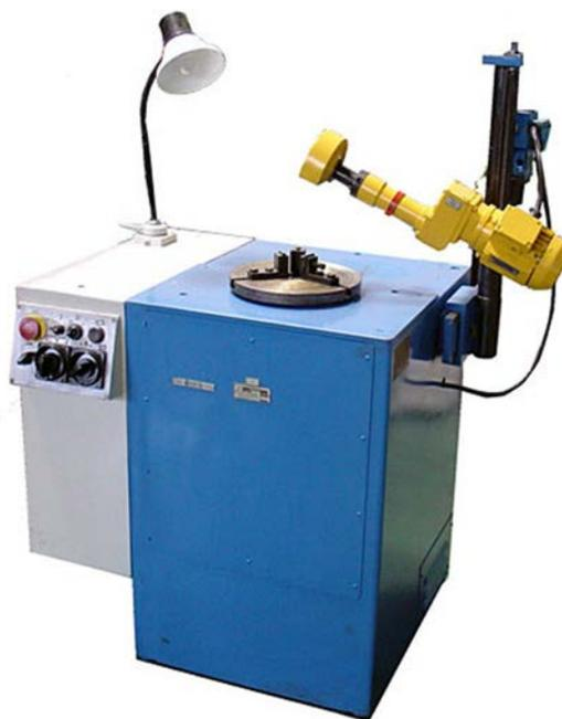
Полуавтомат предназначен для снятия заусенцев и образования фасок по контуру зубьев прямозубых и косозубых зубчатых колес с наружным и внутренним зацеплением, конических, прямозубых и косозубых колес, вал-шестерен, червячных колес и звездочек абразивным кругом.
