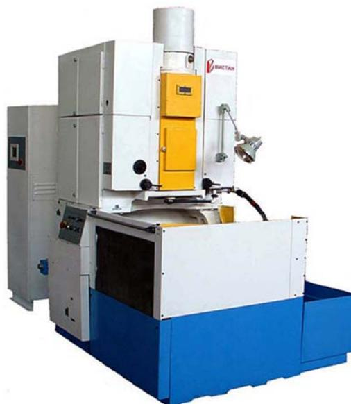
Полуавтомат (BCH-150NC2, BCH-180CNC2) предназначен для нарезания прямых цилиндрических зубчатых колес наружного и внутреннего зацепления дисковыми долбяками методом обката.
