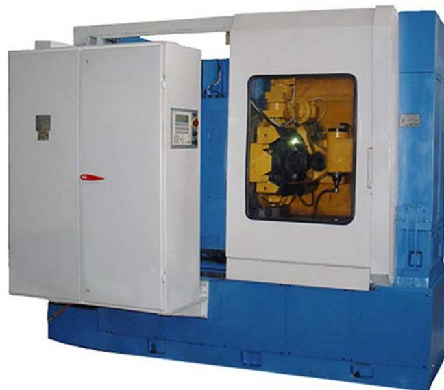
Полуавтомат зубофрезерный BCH-350NC2 предназначен для обработки прямозубых и косозубых зубчатых колес, а также звездочек и червячных колес червячными фрезами методом обката.
