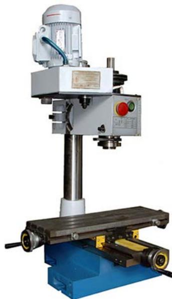
Станок универсальный настольный ВСМ-029 предназначен для выполнения фрезерных и сверлильных работ по металлу, пластмассе. Для индивидуальных потребителей, связанных с обработкой металла и других материалов.
