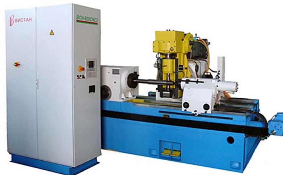
Полуавтомат зубошлицефрезерный повышенной точности с горизонтальной осью изделия предназначен для нарезания шлицевых валов, цилиндрических прямозубых и косозубых колес, а также червячных колес червячными фрезами методом обката.
