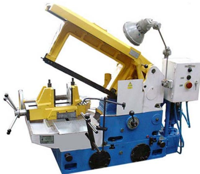
Ножовочно-отрезной станок ВШ-042 предназначен для холодной резки металла. Резка может производиться как в плоскости, перпендикулярной к оси заготовки, так и под углом до  $45^\circ$ .
