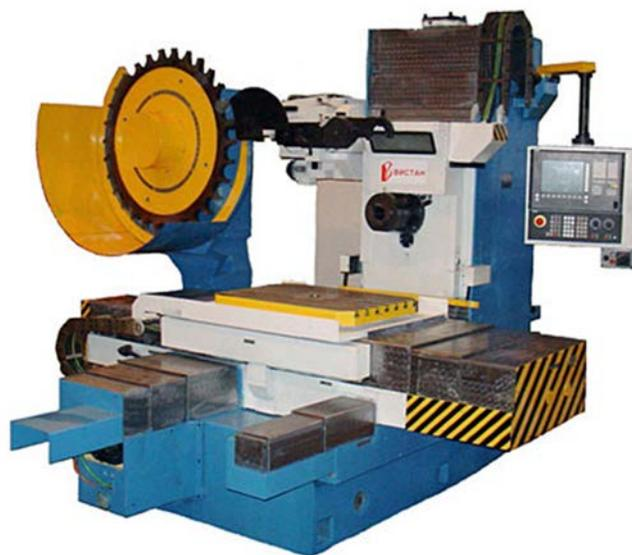
Полуавтомат VCM-206BM-13CNC2 предназначен для комплексной обработки корпусных деталей средних размеров с разных сторон без переустановок по заданной программе.
