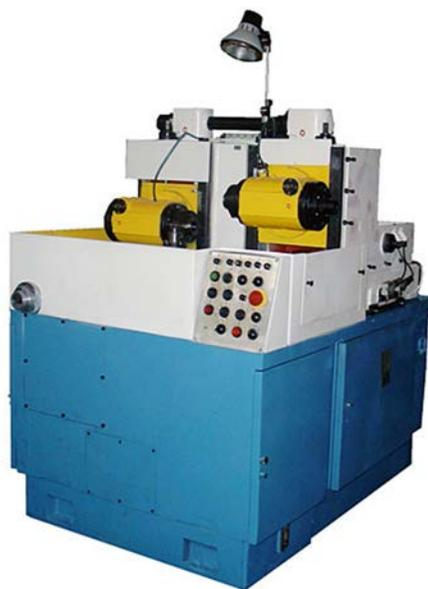
Полуавтомат ВС-500 предназначен для удаления заусенцев и снятия фасок одновитковыми червячными фрезами (фреза-улитка) на одном или двух торцах незакалённых прямозубых и косозубых цилиндрических колёс, а также конических колёс с круговыми зубьями в условиях всех типов производств.
