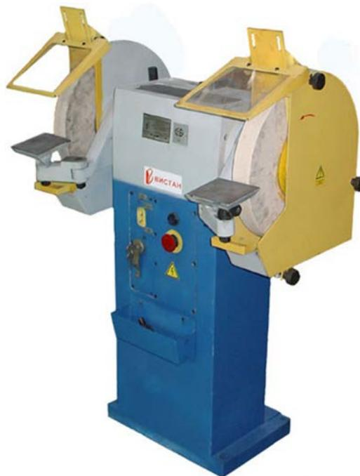
ВШ-041 предназначен для заточки простых инструментов, выполнения слесарных работ и обдирки небольших литых, сварных заготовок. Станок имеет литую станину.
