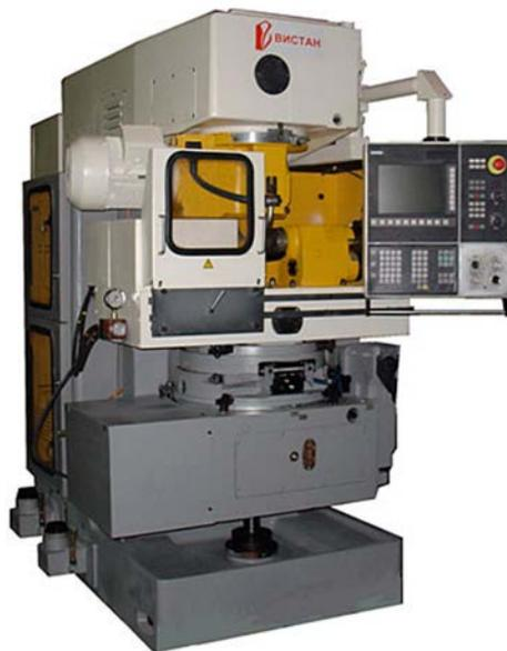
Полуавтомат предназначен для чистовой обработки шевером (после зубофрезерования или зубодолбления и снятия фасок на торцах зубьев) незакаленных прямозубых и косозубых цилиндрических зубчатых колес, а также зубчатых колес с бочкообразной и конической формой зуба методом продольной, диагональной, поперечной и врезной подачи. Полуавтомат имеет компоновку с горизонтальной осью изделия.
