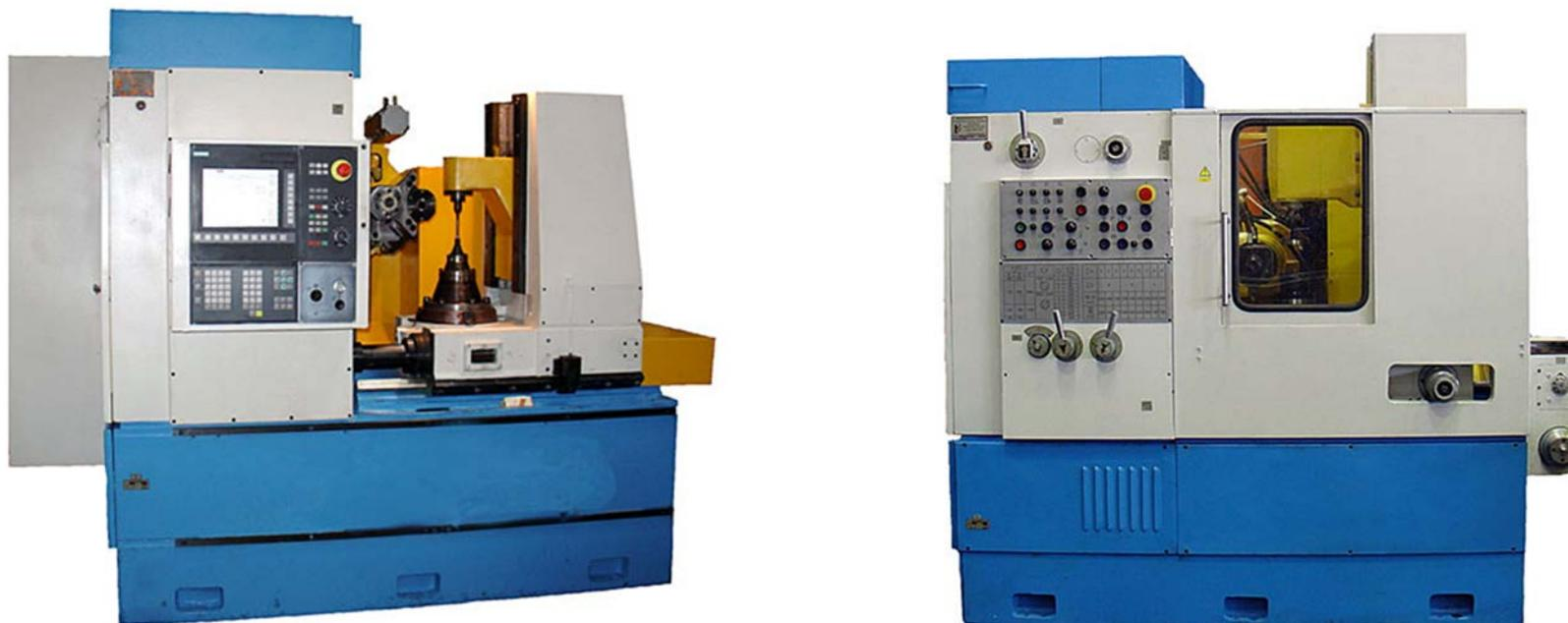
Полуавтомат зубофрезерный универсальный повышенной точности с вертикальной осью изделия для обработки прямозубых и косозубых зубчатых колес и звездочек, червячных колес червячными фрезами методом обката. Полуавтомат имеет компоновку с вертикальной осью изделия и подвижным столом. В шпинделе стола вмонтирован гидроцилиндр Зажима заготовок. С целью использования всей длины режущих кромок червячной фрезы предусмотрено ее периодическое перемещение вдоль оси (шифтинг).
