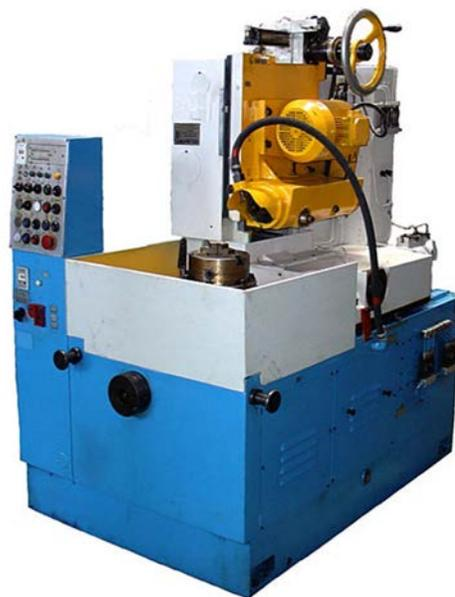
Полуавтомат зубозакругляющий ВС-80 предназначен для закругления торцов, снятие фасок и заострение торцов зубьев цилиндрических зубчатых колёс наружного и внутреннего зацепления специальными фасонными пальцевыми фрезами.
