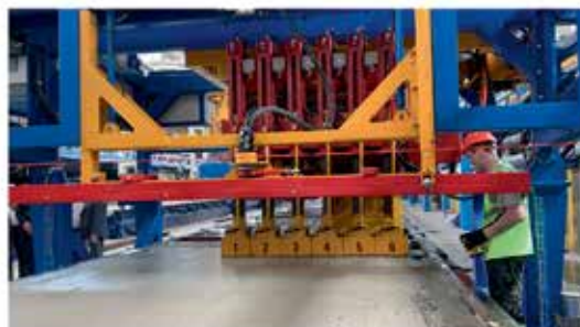
БЕТОНУКЛАДЧИК с возможностью укладки 1-го и 2-го слоя при изготовлении трехслой- ных стеновых панелей
