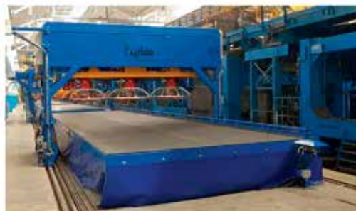
МАШИНА ОТДЕЛКИ бетонных поверхностей
